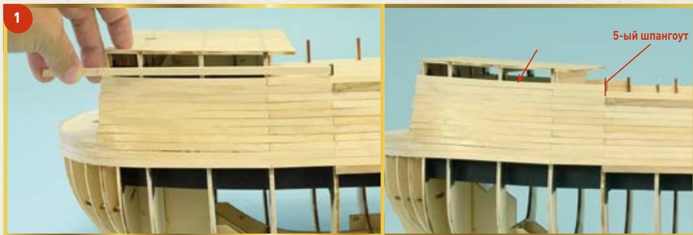
**1** Мы продолжаем работу над черновой обшивкой модели. Возьмите планку и отрежьте от нее фрагмент, длина которого равна расстоянию от середины кромки пятого шпангоута до внешней стороны носовой переборки (это расстояние измерено над самым верхним поясом обшивки левого борта). Приклейте подготовленную планку на свое место и таким образом начните новый пояс обшивки.
