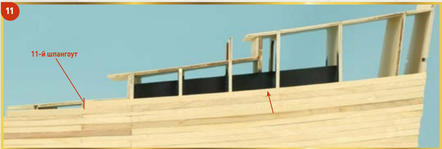
**11** Приклейте планку нового ряда к задней части каркаса, начиная с одиннадцатого шпангоута — над планками, установленными в шагах 9 и 10.
