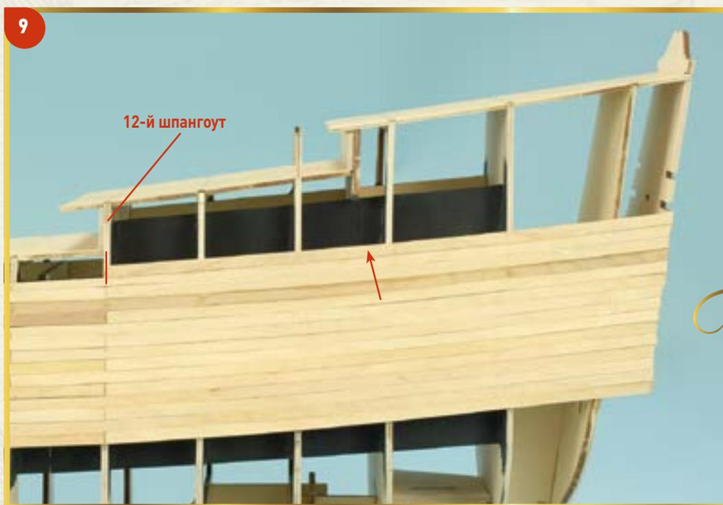
**9** Перейдите к установке следующего пояса обшивки, приклеив к задней части корпуса новую планку так, как показано на фотографии.
