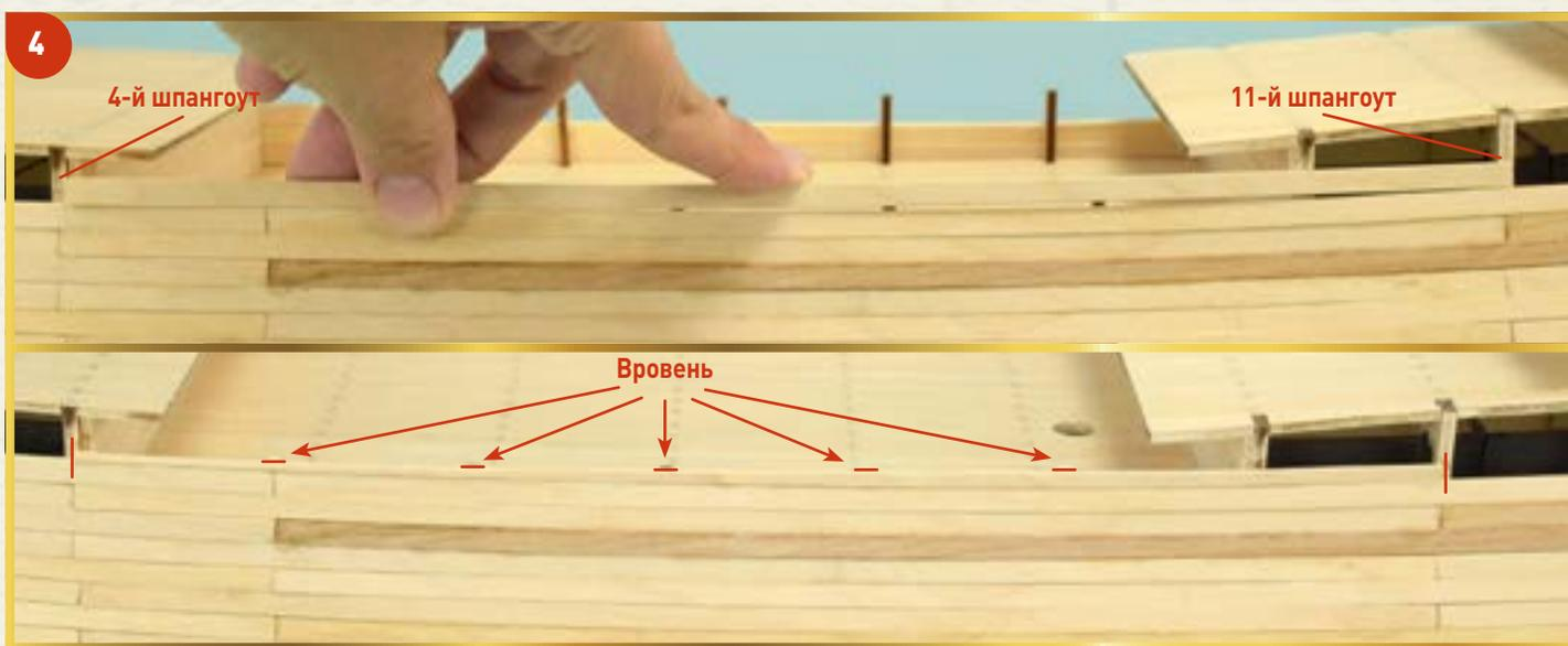
**4** Перейдите к новому поясу обшивки, двигаясь вверх. Приклейте планку к шпангоутам — с четвертого по одиннадцатый. Прежде чем приклеить данную планку, ее нужно подрезать в ширину, чтобы ее верхний край не выступал над верхними оконечностями шпангоутов, указанными на фотографии стрелками.
